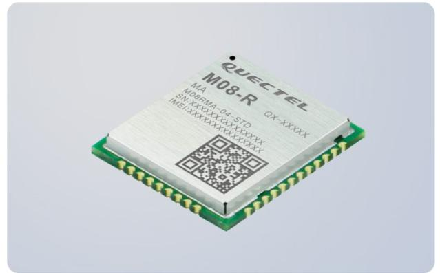
M08-R 是移远通信推出的高性价比、紧凑型四频 GSM/GPRS 模块。模块尺寸仅为 17.6mm × 15.7mm × 2.4mm，能最大限度地满足终端产品对小尺寸模块产品的需求，有助于客户减小产品尺寸，降低产品成本。
