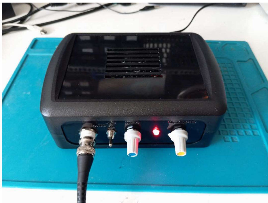
شکل 10: دستگاه ساخته شده درون جعبه، بلندگو در سقف جعبه تعبیه شده است.
